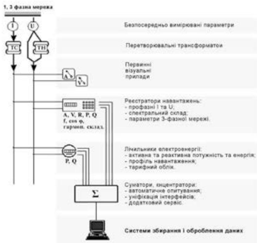
Рисунок 4.4 – Схема вимірювання параметрів електричної енергії
