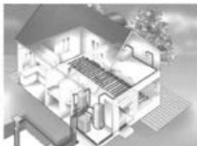
Рисунок 3.44 – Тепловий насос з використанням грунтових вод (система “вода-вода”)
