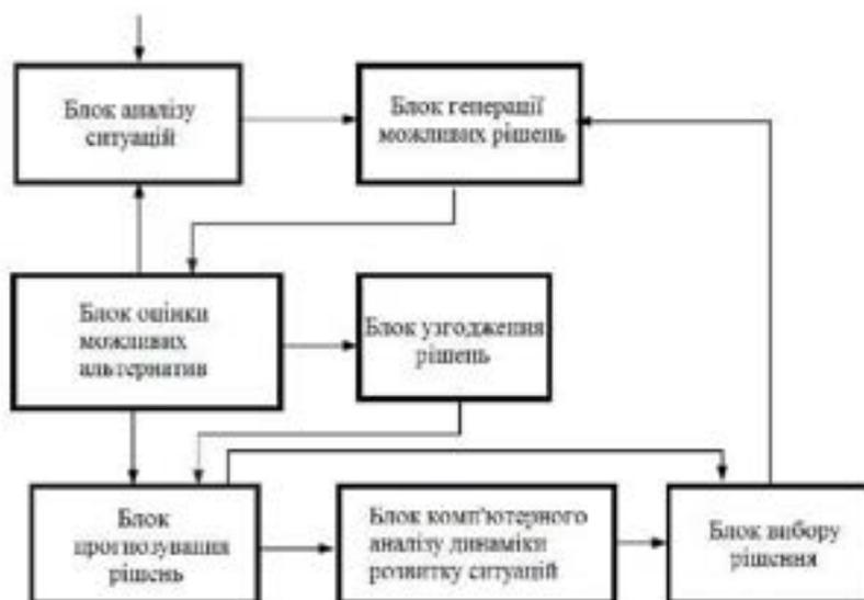
Рисунок 7.7 – Загальна структура системи підтримки прийняття рішень.
