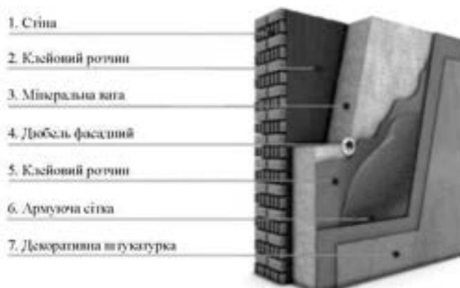
Рисунок 3.29 – Розріз конструкції зовнішніх стін із фасадною теплоізоляцією та опорядженням штукатурками
