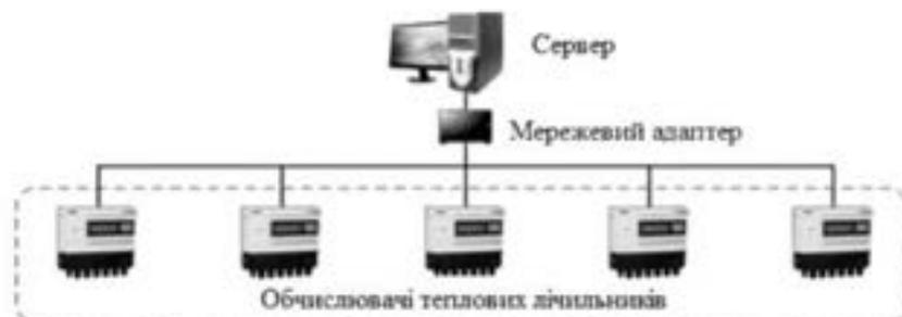
Рисунок 3.51 – Автоматизована система обліку теплової енергії
